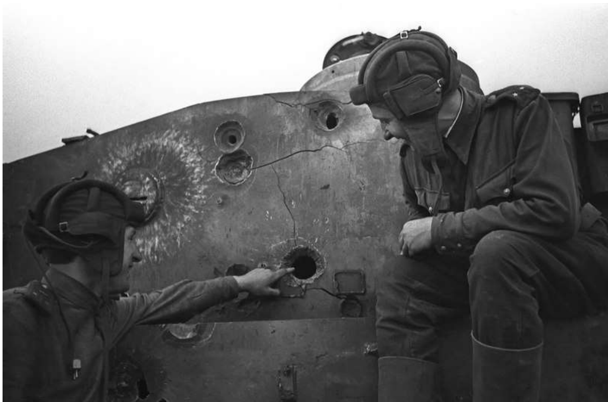
Командир танка, лейтенант Б.В. Смелов показывает пробоину в башне немецкого танка «Тигр», подбитого экипажем Смелова, лейтенанту Лихнякевичу (подбившему в последнем бою 2 фашистских танка) . Эту пробоину сделал обычный бронебойный снаряд из 76-миллиметрового танкового орудия. 27 июля 1943 года.
